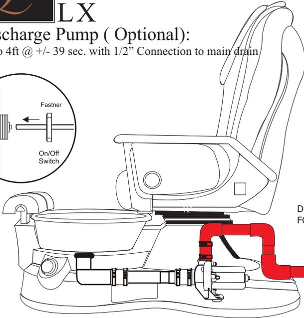
DRAIN OUTLET MUST BE 1/2" FOR EFFICIENT DRAINAGE.
